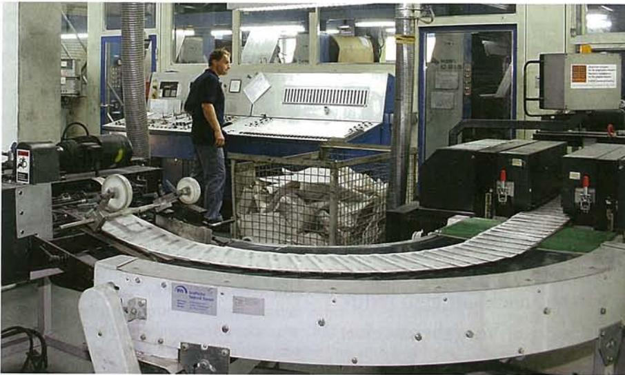
Blick auf die Auslage der Rolle bei AS-Druck in Lahr: Nach dem Druck werden die Produkte kundengerecht dreiseitig beschnitten, gebündelt und verpackt.
